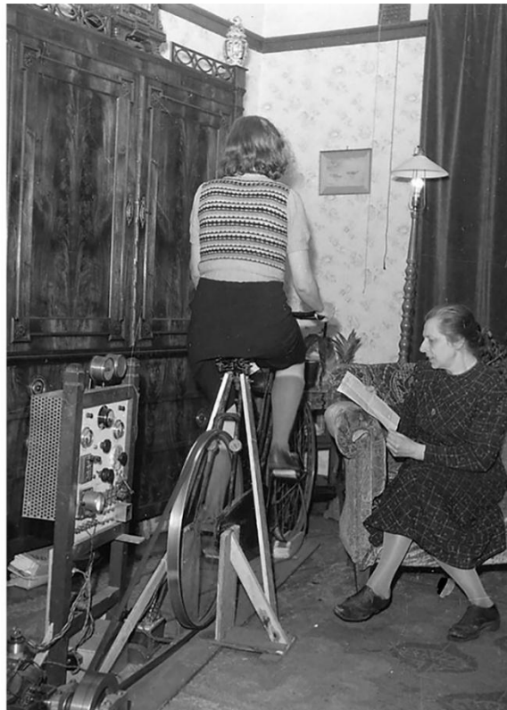
Afbeelding 41: Drie voorbeelden van het gebruik van fietsen om stroom op te wekken in de Tweede Wereldoorlog (bron: Oneindig Noord-Holland, Fotomuseum en Oorlogs- en Verzetscentrum Groningen).
